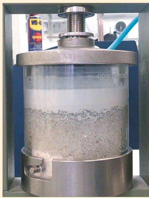
Рис. 3. Процесс фильтрации состава MC-Rock под давлением 6 МПа через кварцевый песок, имитирующий высокопроницаемый коллектор
