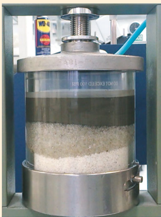
Рис. 1. Процесс фильтрации цемента марки G под давлением 6 МПа через кварцевый песок, имитирующий высокопроницаемый коллектор
