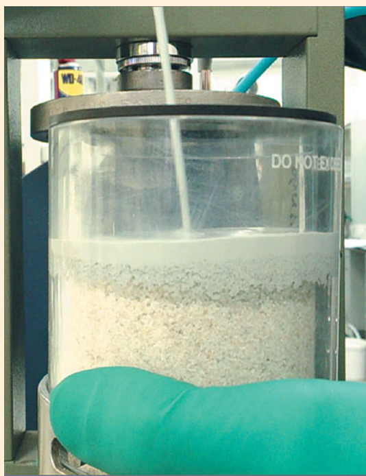
Рис. 2. Процесс фильтрации состава MC-Rock без воздействия избыточного давления через кварцевый песок, имитирующий высокопроницаемый коллектор
