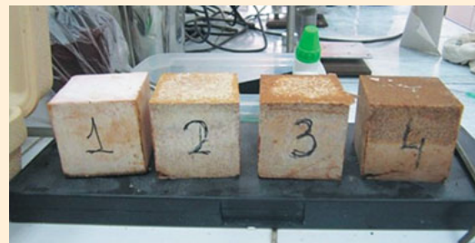
Рис. 4. Камень состава MC-Rock с различной степенью загрязнения раствором на углеводородной основе
