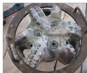
Долото отработало 56 часов в интервале 1714-2533 м на месторождении YIBAL KNUFF в Омане, износ долота 0-0-WT-G-X-I-WT-TD
