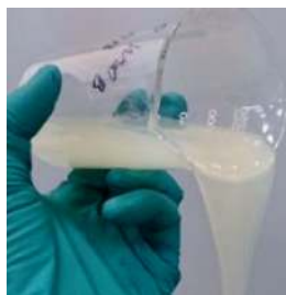
Внешний вид образующейся эластичной, потокоотклоняющей структуры.
