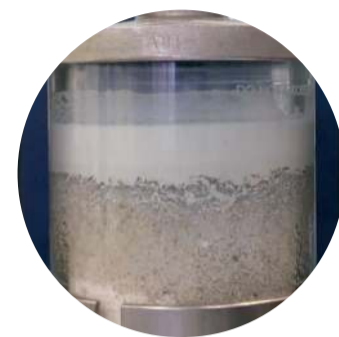
Рис. 3. Процесс фильтрации состава технологии MC-Rock под давлением 100 Psi через кварцевый песок, имитирующий высокопроницаемый коллектор. Видно проникновение вглубь коллектора состава MC-Rock, что впоследствии обеспечит высокое качество проведения РИР.
