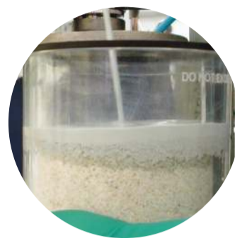
Рис. 2. Процесс фильтрации состава технологии MC-Rock без воздействия избыточного давления через кварцевый песок, имитирующий высокопроницаемый коллектор. Видно, что даже без воздействия избыточного давления состава технологии MC-Rock проникает внутрь коллектора.
