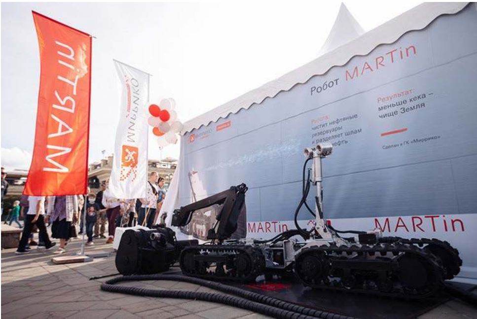
«Миррико» разработала роботизированную очистку резервуаров от нефтешламов MARTin
