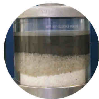
Рис. 1. Процесс фильтрации цемента под давлением 100 Psi через кварцевый песок, имитирующий высокопроницаемый коллектор. Даже под давлением цемент не проникает в коллектор, отфильтровывается только вода, содержащаяся в цементе.
