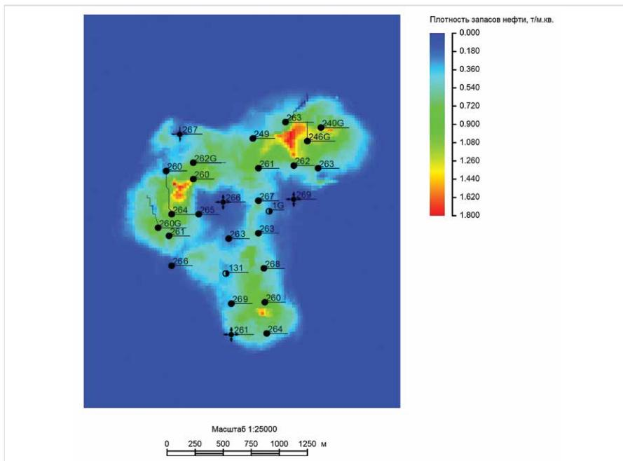
Рис. 5 – Карта остаточных запасов нефти визейского объекта разработки
